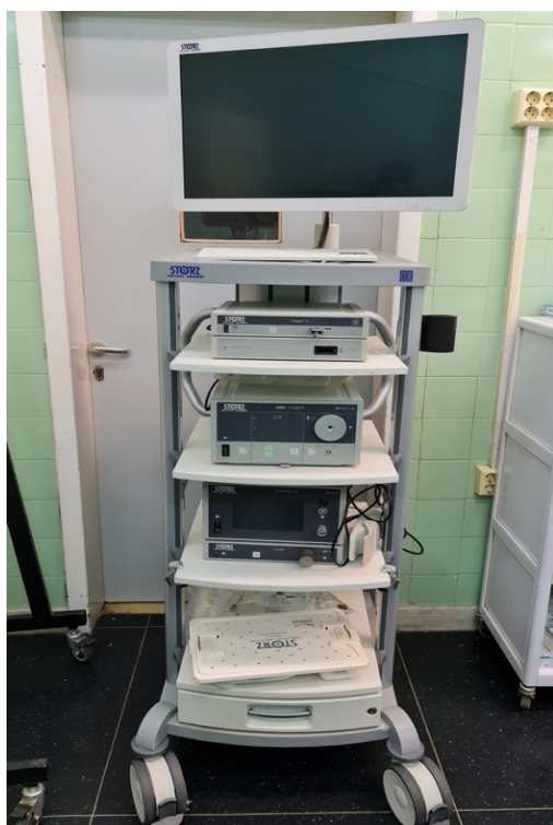
Εικόνα 1. Ενδοσκοπικός πύργος. Από επάνω προς τα κάτω αναγνωρίζεται η οθόνη, το σύστημα λήψης εικόνας, η πηγή φωτισμού και το σύστημα-αντλία έκπλυσης.
